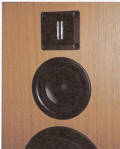
Particolare dei driver per le vie alte.
